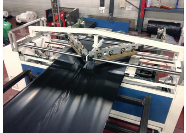
**Sealine 45°** "brevettato" è un gruppo di saldature oblique sui soffietti che consente di migliorare le caratteristiche tecniche del sacco dando così un valore aggiunto al prodotto finito. È un accessorio altamente versatile e adattabile su qualsiasi impianto, direttamente in linea all'estrusore o in linea a saldatrici per sacchi o rotoli.
